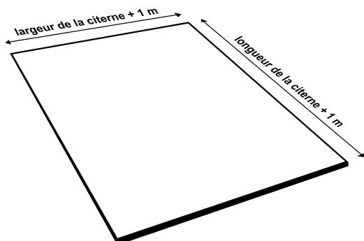
Sol propre et stabilisé + lit de sable (0/2) 10 cm (+/- 2 cm)
